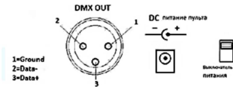
Примечание: некоторые приборы могут иметь отличную от стандартной (*data +/-*) полярность сигнала на разъемах DMX. Убедитесь, что полярность DMX сигнала на контроллере и у приборов, подключенных к нему одинакова.
