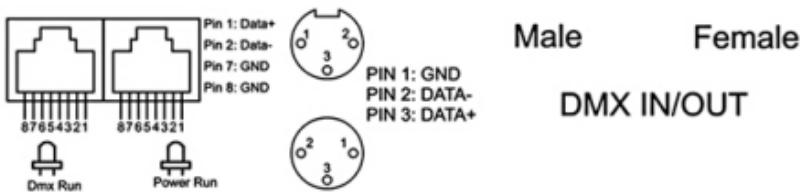
На конце кабеля максимально удаленного от передающего устройства устанавливается так называемый терминатор - нагрузочный резистор между двумя проводами с данными (штырьки 2 и 3 разъема XLR). Резистор-терминатор поглощает сигнал на дальнем конце кабеля и не позволяет ему отражаться. В качестве терминаатора обычно используется резистор номиналом 120 Ом мощностью 0,25 Вт. Терминатором также может служить 3-х штырько-
