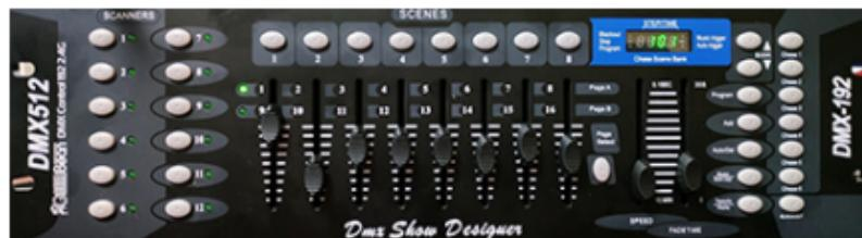
Кнопки **SCANNERS** (выбор прожектора) прожектор - любое исполнительное устройство, с количеством DMX-параметров (каналов управления) от 1 до 16. Для выбора устройства коротко нажмите кнопку, индикатор рядом с ней включается.
