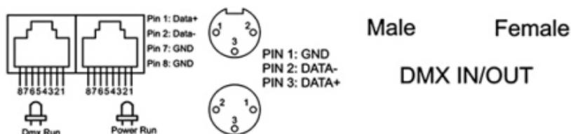
На конце кабеля максимально удаленного от передающего устройства устанавливается так называемый терминатор - нагрузочный резистор между двумя проводами с данными (штырьки 2 и 3 разъема XLR). Резистор-терминатор поглощает сигнал на дальнем конце кабеля и не позволяет ему отражаться. В качестве терминатора обычно используется резистор номиналом 120 Ом мощностью 0,25 Вт. Терминатором также может служить 3-х штырько-
