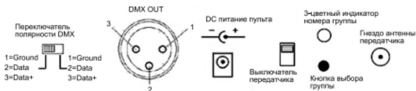
Переключатель полярности DMX: некоторые приборы могут иметь отличную от стандартной (data +/-) полярность сигнала на разъемах DMX. Убедитесь, что полярность DMX сигнала на контроллере и у приборов, подключенных к нему одинакова.
