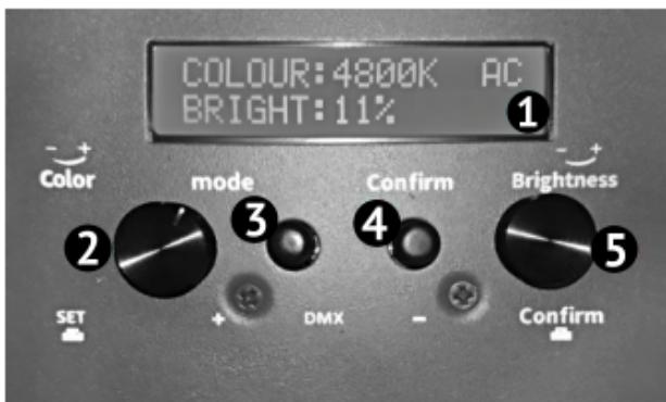
**1. ЖК панель; 2. Кнопка-валкодер COLOR/SET; 3. Кнопка MODE/DMX -; 4. Кнопка CONFIRM/DMX +; 5. Кнопка-валкодер BRIGHTNESS/CONFIRM**
