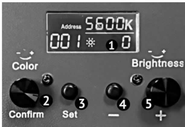
**1. ЖК панель; 2. Кнопка-валкодер COLOR/CONFIRM; 3. Кнопка SET; 4. Кнопка “-”; 5. Кнопка-валкодер BRIGHTNESS / “+”**
