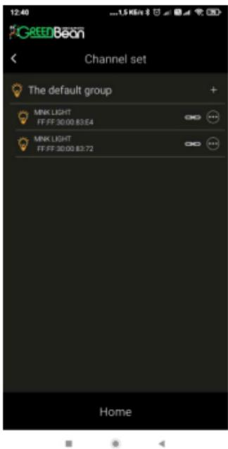
После включения питания осветителя его имя Bluetooth появляется в списке устройств в группе по умолчанию. Справа символ подключения, тап на него отключает устройство. Имя устройства можно изменить. Все подключенные устройства группы управляются синхронно. Чтобы разделить устройства, создайте и назовите новую группу и добавьте в нее нужные устройства, сделайте группу активной (символ группы подсвечен). Все устройства в активных группах будут управляться синхронно.
