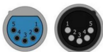
PIN 1 – общий (экранирующий) провод;
