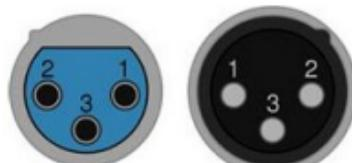
PIN 1 – общий (экранирующий) провод;
